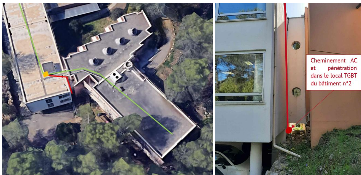
Figure 10 – Passage des câbles AC bâtiment n°2
